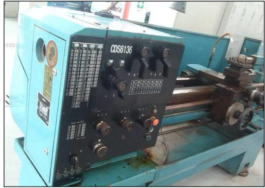
机床本体卫生打扫干净 各部件上不得有杂物，用抹布擦拭干净 擦拭干净后在机床没有喷式油漆部件上 涂抹机油如：卡盘、导轨、刀架尾座等
