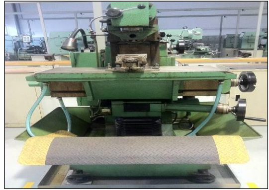
机床停止、归位 x 轴、y 轴、z 轴归位位置如图所示
