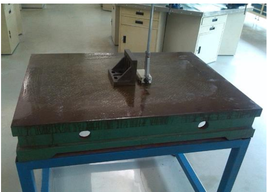
把高度游标尺、角铁或 V 型铁放在中间位置
