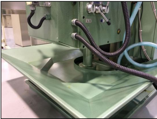
机床铁屑盘卫生打扫整洁； 打扫卫生时避免遗漏铁屑盘内的铁屑， 将铁屑盘取下，铁屑清理干净后再装上。
