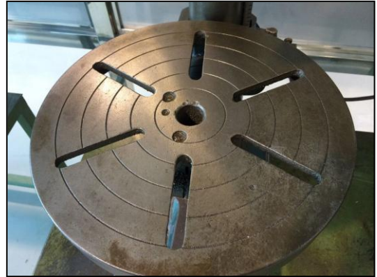
机床本体卫生打扫干净； 各部件上不得有铁屑，用抹布擦拭干净后，在机床没有喷漆部件上涂抹机油如：工作台面、升降台齿条等。
