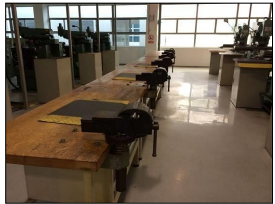
工作台四周卫生打扫整洁；虎钳口自然 合上，手柄下垂不歪斜，脚垫放在桌上， 抽屉关上锁好
