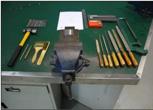
钳工操作中 工量具摆放如图示，整齐，整洁，使用 完毕后正确归位。
