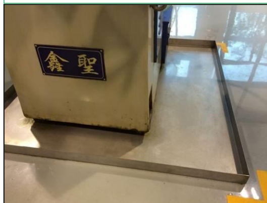
机床本体卫生打扫干净； 各部件上不得有铁屑，用抹布擦拭干净后，在机床没有喷式油漆部件上涂抹机油如：工作台面等。
