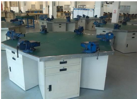
工作台四周整洁卫生，虎钳口自然合上，手柄下垂不歪斜，脚垫放在桌上，抽屉和门关上锁好
