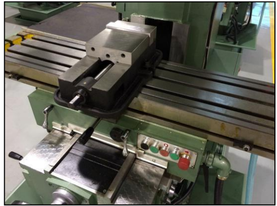
机床本体卫生打扫干净； 各部件上不得有铁屑，用抹布擦拭干净后，在机床没有喷漆式油漆部件上涂抹机油如：虎钳、工作台面、导轨等。
