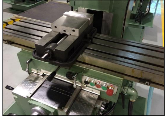
机床本体卫生打扫干净；各部件上不得有铁屑，用抹布擦拭干净后，在机床没有喷式油漆部件上涂抹机油如：虎钳、工作台面、导轨等。
